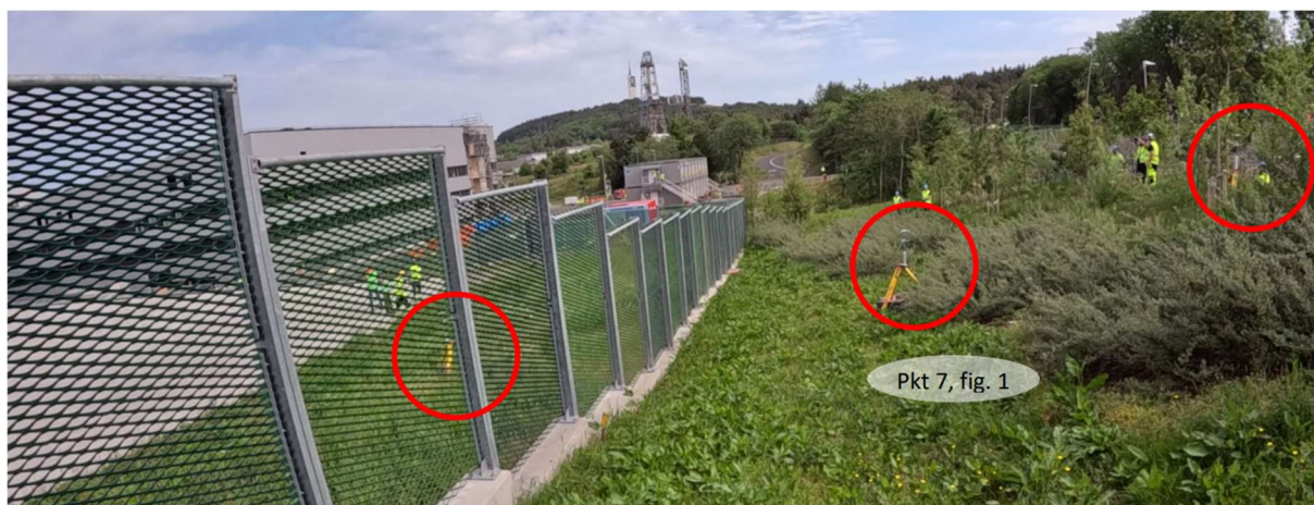
Figur 13 Lokalisering av 3D Sonic Anemometer på begge sider av blast fence øst for helipad
